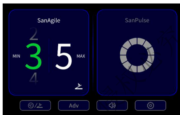
图 2.27 手控开关、脚踏开关均可激发（小档，默认 3 档）
