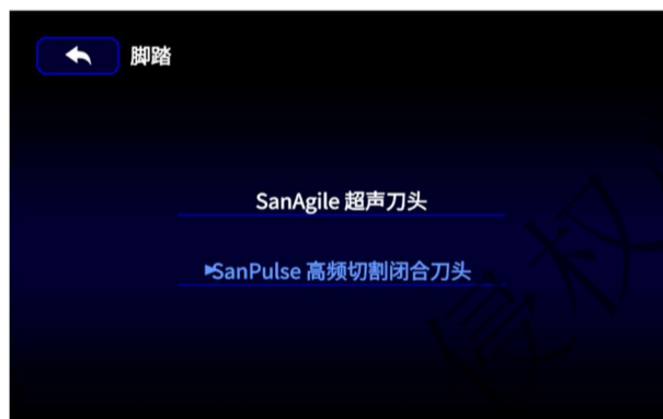
图 4.4 脚踏开关分配给一次性使用高频切割闭合器械使用
