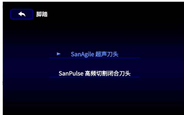
图 4.3 脚踏开关分配给超声刀头使用
