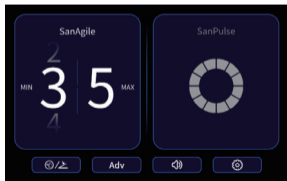
图 2.11 一次性使用超声软组织手术刀头连接发生器 (SASG17/9F) 每次开机保持默认设置值：小档 MIN 值为 3，大档 MAX 值为 5，且屏幕上 SanAgile 超声刀头区域由灰暗变亮。如下：
