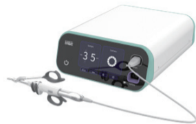
图 2.11 一次性使用超声软组织手术刀头连接发生器 (SASG17/9F) 每次开机保持默认设置值：小档 MIN 值为 3，大档 MAX 值为 5，且屏幕上 SanAgile 超声刀头区域由灰暗变亮。如下：
