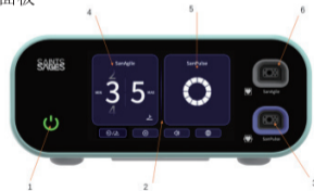
图 1.2 发生器前面板
